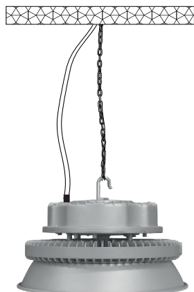
Montaż na zawieszach/Mounting on suspensions/На подвесах
